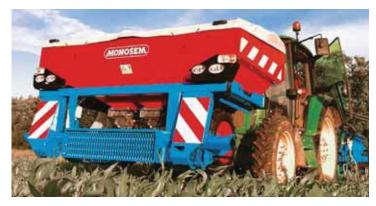
Der DUO-Frontbehälter ist mit einem Inhalt von 1500 L oder 2100 L erhältlich. Das Gesamte lässt sich auf die 12-reihigen CRT-Sämaschinen bauen. Dieser Düngerstreuer verfügt über ein doppeltes Dosierungssystem aus Edelstahl und über ein Schaltgetriebe zur raschen und präzisen Aussaateinstellung.
