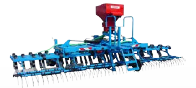
Klappbar auf 2,5 m mit zweifacher Sicherung (hydraulisch und mechanisch) Straßensignalisierung und Beleuchtung inklusive
