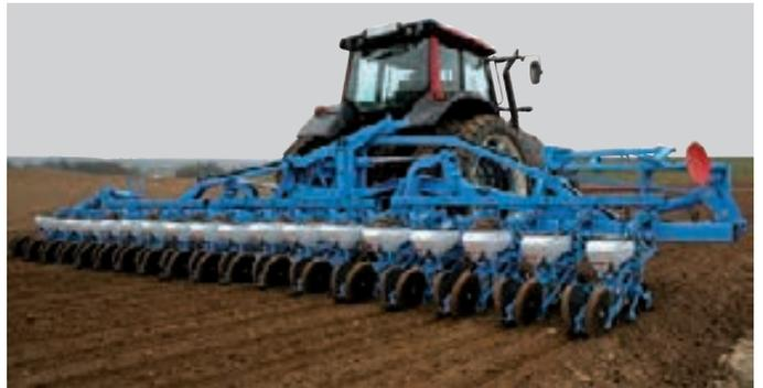
18-reihige dreistufige klappbare MECA V4-Einzelkornsämaschine
