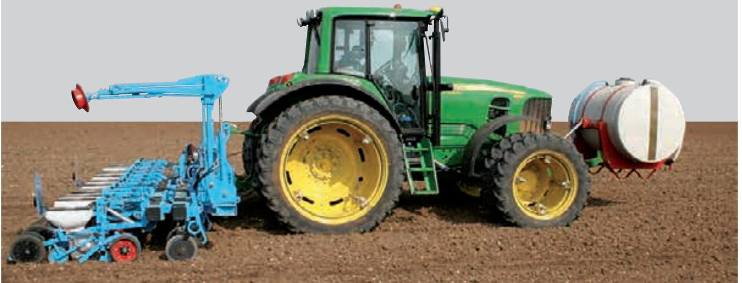
Die MECA-V4-Sämaschinen können mit einem Flüssigdüngungssystem ausgerüstet werden. Hierfür verweisen wir auf die Flüssigdünger-Spezialisten (1).
