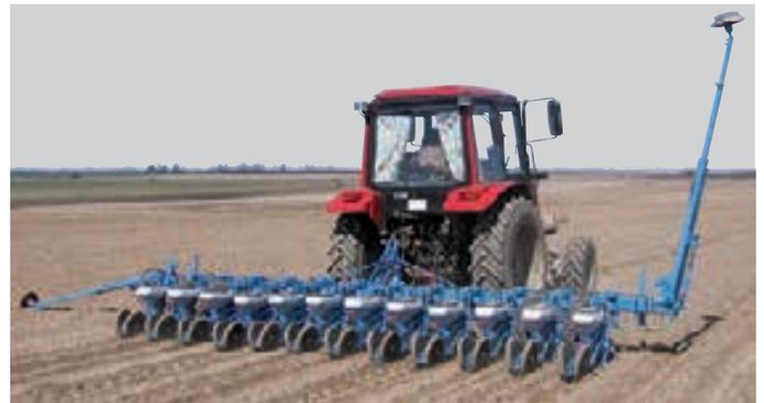
Starre 12-reihige MECA V4-Einzelkornsämaschine mit einfachem Rahmen
