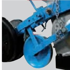
Die mit Edelstahl überzogene und mit plastik-Abstreifern ausgerüstete Anpressrolle sichert dem Samen einen optimalen Bodenkontakt. Der Druck der einziehbaren Anpressrolle ist einstellbar.
