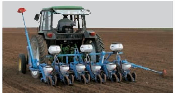
Starre 6-reihige MECA V4-Einzelkornsämaschine mit einfachem Rahmen und Microsem
