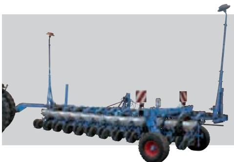
Starre 12-reihige MECA V4-Einzelkornsämaschine mit Langfahrvorrichtung
