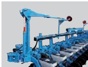
Die Spuranzeiger für starre und gekoppelte Rahmen sind je nach Sämaschinenbreite einfach-, doppelt- oder dreifach-klappbar (Bild oben: Spuranzeiger für starren 18-reihigen Rahmen).
