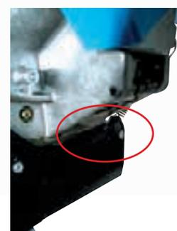
Die Zellen der Aussaatüberwachung sind unter den Dosier-Gehäusen in den Säscharen der Säe-elemente angeordnet. Ein Lichtstrahl kontrolliert den Durchgang der Saatkörner, sogar der kleinsten.
