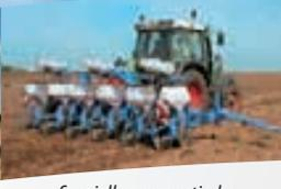
Spezielle pneumatische Einzelkornsämaschine für Direktsaat Typ NX mit Scheiben
