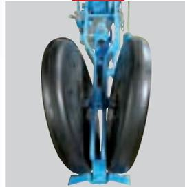
Zwei schräg angeordnete 2“-Räder mit selbstreinigender Bereifung gewährleisten ein optimales Schließen der Saatfurche. Der Bodendruck dieser Räder ist einstellbar. Die Räder sind mit Abstreifern und verstärkten Kugellagern versehen.
