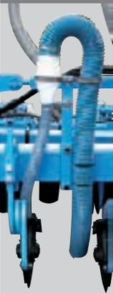
Ein Zyklon je Säelement sichert, dass das Mikrogranulat vom Luftstrom getrennt wird und durch sein eigenes Gewicht auf den Boden fällt. So wird auch die Staubbildung begrenzt, die durch die Umwälzluft verursacht wird.
