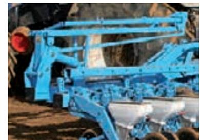
Die Spuranzeiger für klappbare Rahmen verfügen über ein kompaktes Klappsystem (Bild oben: 3-stufiger Spuranzeiger für klappbaren Rahmen).
