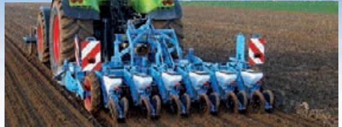
Starre 6-reihige MECA V4-Einzelkornsämaschine mit einfachem Rahmen
