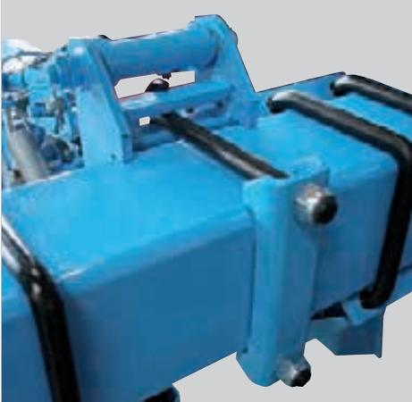
Das Befestigungssystem der Dosiereinheit durch Bügel erlaubt deren sichere und solide Befestigung. Bei Bedarf können die Dosiereinheiten durch Lockern der Bügel verschoben werden, um den Reihenabstand zu verändern. Dieses Befestigungssystem schließt jegliches Risiko einer seitlichen Verlagerung der Dosiereinheit während des Arbeitens aus und hält den schwierigsten Einsatz-Bedingungen stand.
