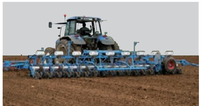
Starre 18-reihige MECA V4-Einzelkornsämaschine mit Dreifach-Rahmen und Langfahrvorrichtung
