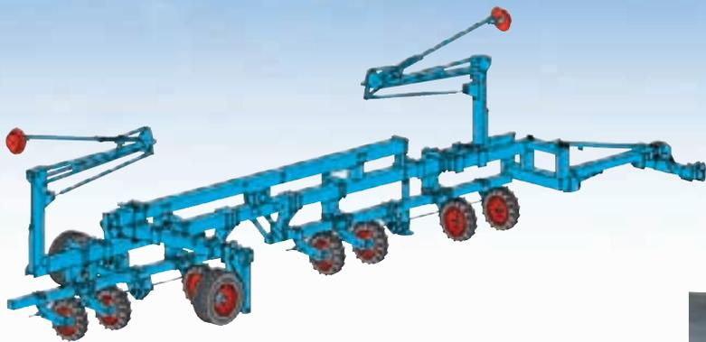
24-reihige gekoppelte MECA V4-Einzelkornsämaschine mit Microsem
