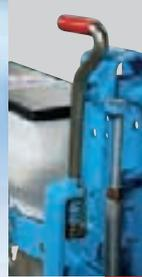
Die Tiefeneinstellung erfolgt schnell und präzise bei den „fronttiefengeführten Elementen“ über einen Einstellhebel und bei den „Tandem-Elementen“ über ein Einstellrad. Die Einstellgenauigkeit erreicht bei der Hebeleinstellung 5 mm und bei den „Tandem-Elementen“ 1 mm.
