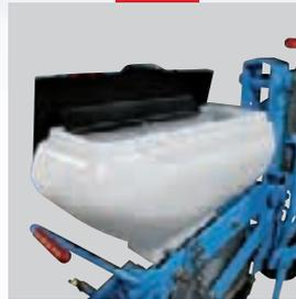
Der stabile Saatgutbehälter aus durchsichtigem Kunststoff verfügt über 8 Liter Inhalt.
