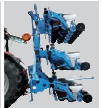
18-reihige dreistufige klappbare MECA V4-Einzelkornsämaschine in Transportstellung
