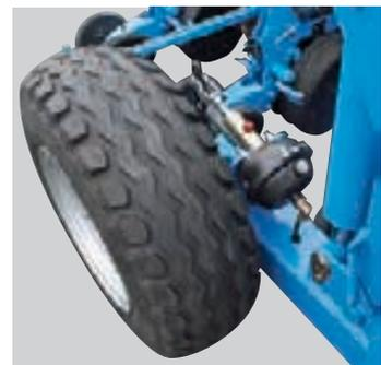
Das Befestigungssystem der Sämaschine auf dem Trägerbalken erlaubt, dass sich jedes Element optimal dem Boden anpasst.
