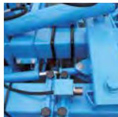
Die Korrekturzylinder leiten die Hackmaschine nach links oder rechts um, unabhängig der Lage des Traktors, um ein pflanzennahes Hacken zu gewährleisten.
