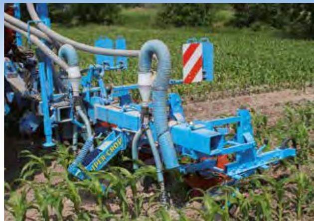
Die Standardschnecken (A), in blau, erlauben eine Dosierung von 80 bis 350 kg/ha bei 75 cm Reihenabstand und von 120 bis 525 kg/ha bei 50 cm Reihenabstand.
