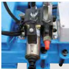
Die Ölversorgung der Hydraulik erfolgt durch eine einwirkende mit freiem Rücklauf.
