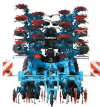
Dank der Klappung des Rahmens in 5 Teile und mit der individuellen Aushebung des Elementes ist die «große Breite» Hackmaschine nicht mehr als 3m breit in Transportstellung.
