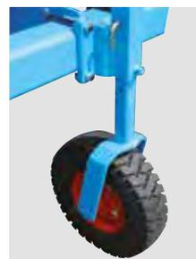
Um die Hackmaschine genau in der Höhe zu führen, sind die großräumigen Düngerstreuer mit Stützrädern ausgestattet.
