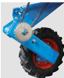
Das Bodenantriebsrad gewährleistet eine präzise, proportionale und regelmäßige Düngerdosierung. Der große Ausschlag sichert in allen Einsatzbedingungen einen regelmäßigen Beitrag.
