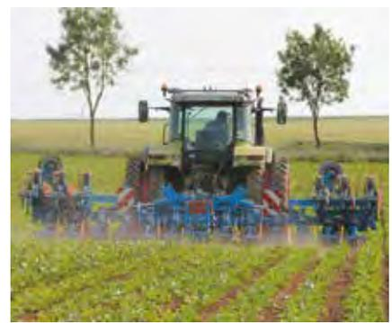
Teilweise geklappt, kann die «große Breite» Hackmaschine auch 8 Reihen Mais oder 12 Reihen Zuckerrüben hacken. Damit kann eine einzige Hackmaschine benutzt werden für Felder, die mit Sämaschinen mit verschiedener Breite gesät worden sind.
