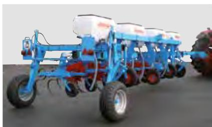
Um den Straßentransport der großen Hackmaschinen zu vereinfachen, ist optional ein Langfahrvorrichtung verfügbar. Diese Vorrichtungen kann mechanisch bzw. hydraulisch angehoben werden.
