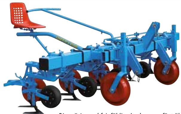
Die präzise und feinfühligke Lenkung verfügt über ein integriertes Sperrsystem.
