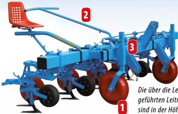
Die über die Lenkstange (2) geführten Leiträder (1), sind in der Höhe einstellbar (3).
