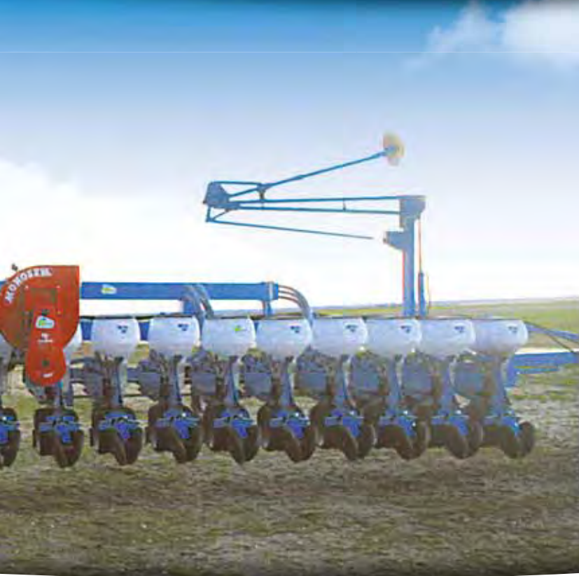
18-reihige, gekuppelte Sämaschine (45 cm Reihenabstand).
