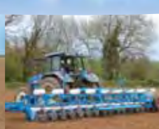
mechanische Einzelkornsämaschine Typ MECA V4 für Zuckerrüben
