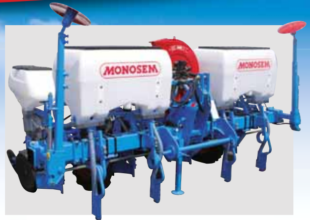
Starre 4-reihige, Monobar-Sämaschine (75 cm Reihenabstand).
