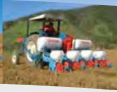
pneumatische Einzelkornsämaschine Typ NC mit Schar
