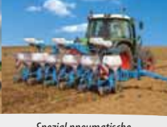
Spezial pneumatische Einzelkornsämaschine NX 2 für « Minimalbodenbearbeitung » mit Doppelsätscheiben
