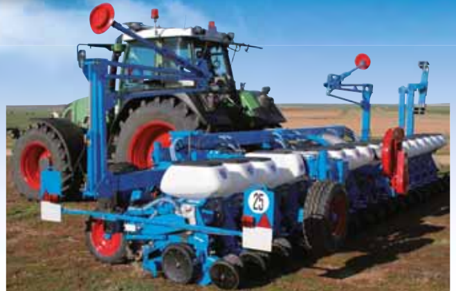
18-reihige, gekuppelte Sämaschine (45 cm Reihenabstand).
