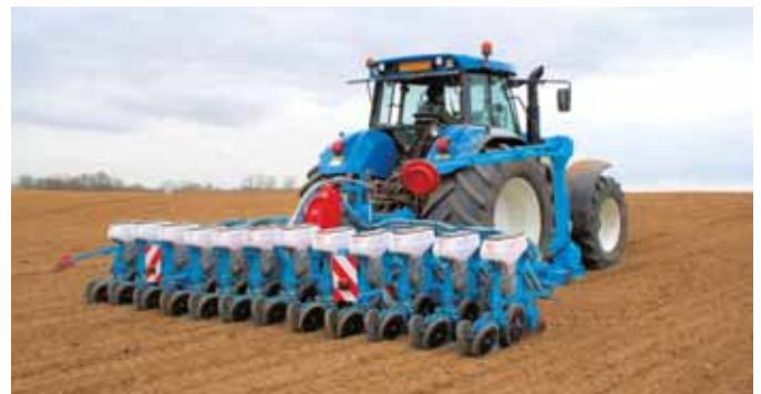
12-reihige, klappbare Doppelbalken-Sämaschine (45 cm Reihenabstand)
