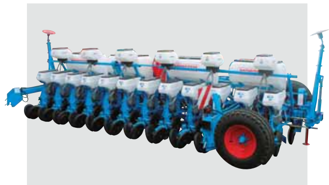
Starre 12-reihige, doppelbalkige Sämaschine (45 cm Reihenabstand) mit Längstransportwagen.
