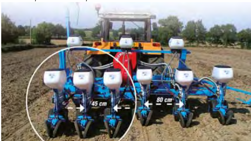
Die 6-reihige Extend-Ausführung erlaubt Reihenabstände von 45, 50, 55, 60, 65, 70, 75 und 80 cm.
