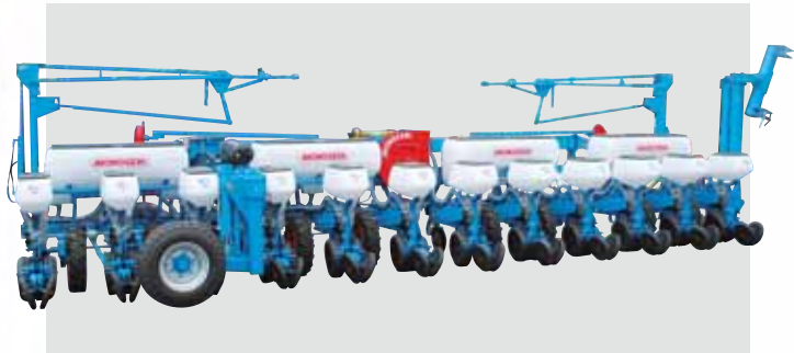
12-reihige, gekuppelte Sämaschine (75 cm Reihenabstand).
