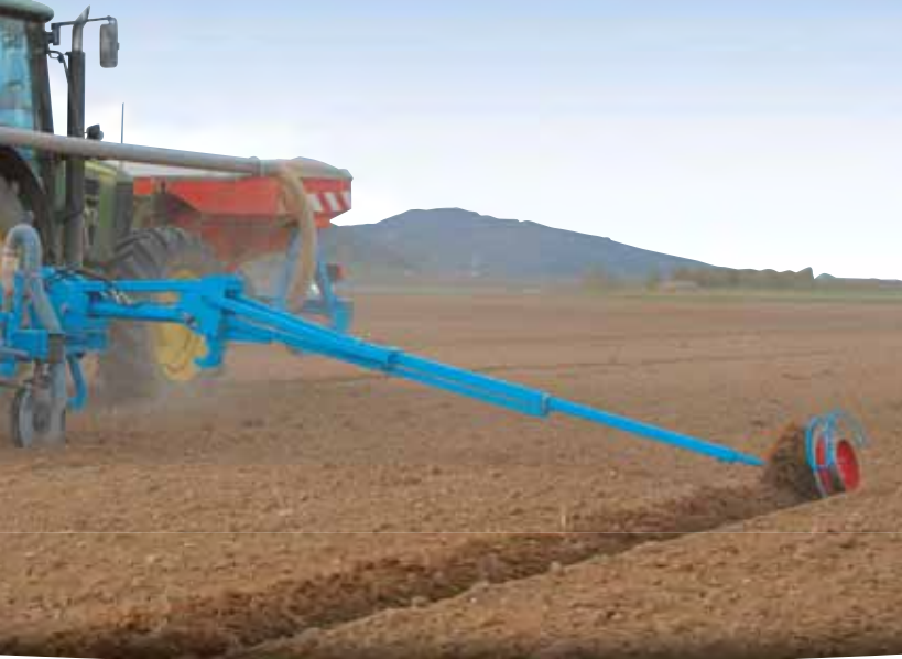
8-reihige, klappbare Doppelbalken-Sämaschine (75 cm Reihenabstand)
