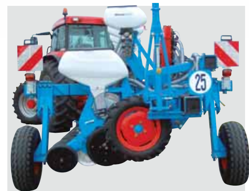
Für überbreite Sämaschinen ist ein mechanisch-oder hydraulisch-bedinbarer Längstransportwagen verfügbar.
