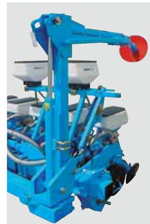
12-reihige, klappbare Doppelbalken-Sämaschine (45 cm Reihenabstand)
