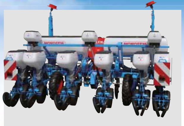
6-reihige, einfache Monoblock-Sämaschine mit Teleskoprahmen (75 cm Reihenabstand).
