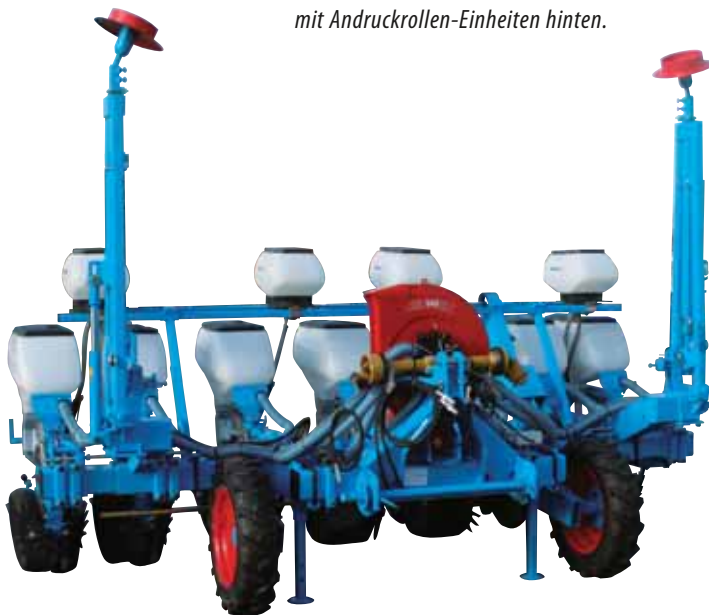
Sägerät mit Front-Andruckrolleneinheiten für das Säen mit verringerten Reihenabständen (bis zu 37,5 cm) oder bei steinigem Boden.
