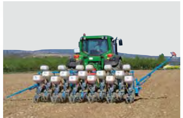
Starre 11-reihige Monoblock-Sämaschine (37,5 cm Reihenabstand oder 6-reihig und 75 cm Reihenabstand).
