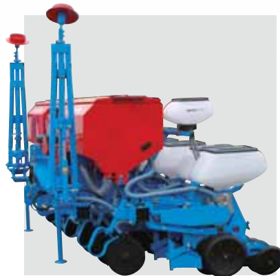
Der Monoblock-Rahmen 260 mit großem Überstand kann mit "großräumigem" Düngestreuer ausgerüstet werden.
