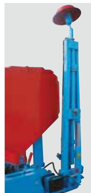
Hydraulische Spuranzeiger sind serienmäßig auf allen Sämaschinen.
