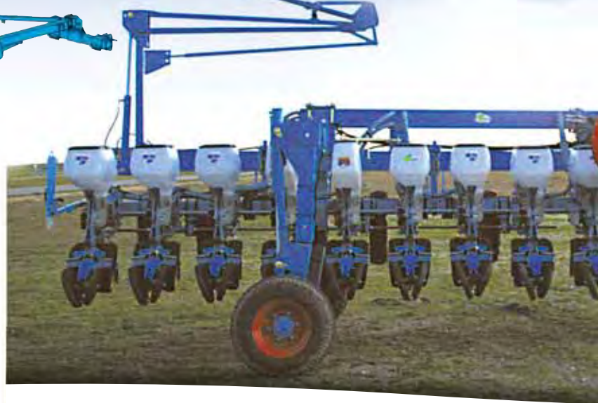
18-reihige, gekuppelte Sämaschine (45 cm Reihenabstand)
