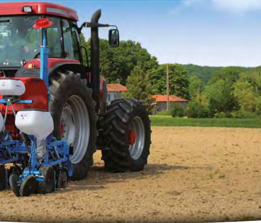
6-reihige, einfache Monoblock-Sämaschine mit Teleskoprahmen (75 cm Reihenabstand).
