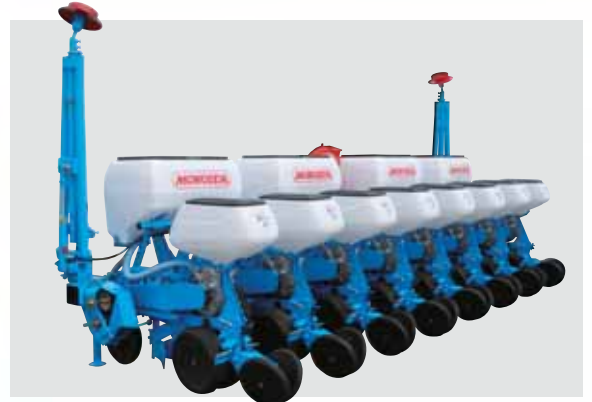
Starre 8-reihige, doppelbalkige Sämaschine (70 cm Reihenabstand).
