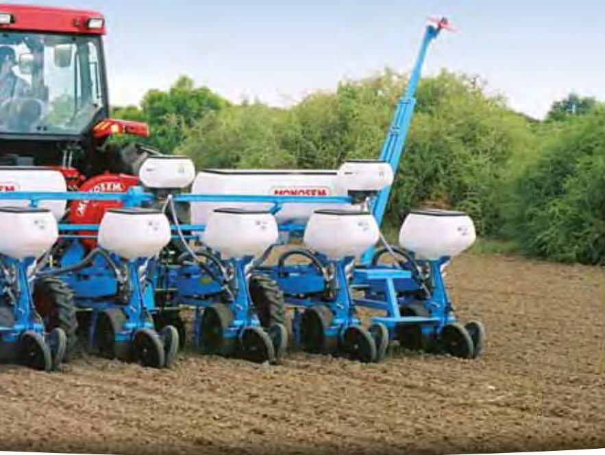
Starre 4-reihige, Monobar-Sämaschine (75 cm Reihenabstand).
