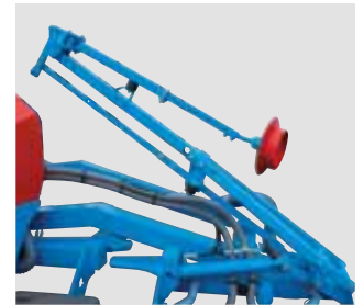
8-reihige, klappbare Sämaschine mit starrem TFC Rahmen (75 cm Reihenabstand)
