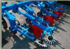
Hinten am Hackelement an S-förmiger Halterung montierter Hackstern mit Ø 360 mm für Zwischenreihen von 0,45 bis 0,80 m
