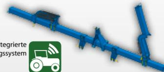
**Hydraulisch klappbar bis 7 m: Rahmen aus Vierkantrohr 120 x 5 mm**
