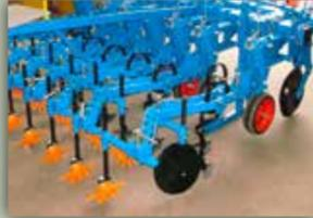
Hinten am Hackelement montierter Hackstern mit Ø 360 mm für Zwischenreihen von 0,60 bis 1 m
