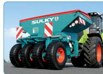
Frontpacker PACK DRIVE® für eine gleichmäßige und kontinuierliche Rückverfestigung des Bodens zwischen den Traktorrädern.
