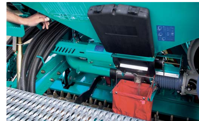
Das Dosierorgan von SULKY verschafft Ihnen eine hohe Schlagkraft – sowohl bei der Aussaat auf dem Feld wie bei den Einstellarbeiten. Bei der Abdrehprobe muss nichts abgebaut werden, alle Einstellungen sind zentral um das Dosierorgan herum angeordnet.
