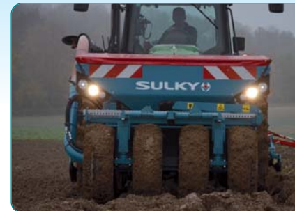
LED-Arbeitsscheinwerfer mit separater Betätigung. Warn- und Beleuchtungseinrichtung für die Straßenfahrt (Abblendlicht, Blinker rechts/links und Standlicht).
