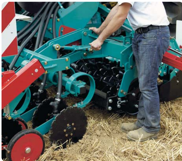
Zentrale Verstellung über Parallelogramm : einfach zugänglich auf der Maschinenseite, für eine Millimeter genaue Einstellung der Arbeitstiefe.
