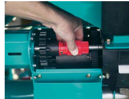
Universal-Dosierorgan: Universal-Dosierorgan: Umstellung von Feinsaaten auf grobkörniges Saatgut durch einfache Umschaltung der Klaue.
