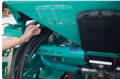
Elektrischer Antrieb des Dosierorgans: Zusatzausrüstung bei XEOS HD, serienmäßig bei XEOS PRO. Hier zu sehen ist die Entleerung des Dosierorgans über fernbetätigte, hinten am Saatgutbehälter angebrachte Taste zum Ein- und Ausschalten des elektrischen Motors.
