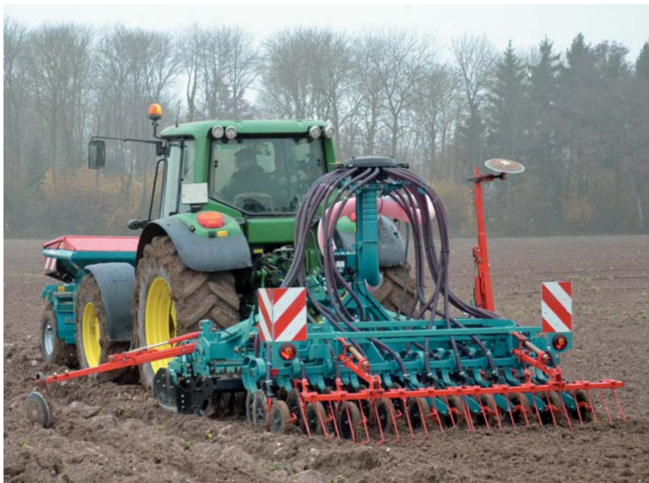
Da Cultidisc für Einsätze ohne Andruckrolle konzipiert wurde, sind einer Aussaat in sehr feuchtem Boden nahezu keine Grenzen gesetzt.
