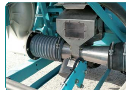
Edelstahl-Dosierorgan zum Wiegen von Saatgut oder Dünger.
