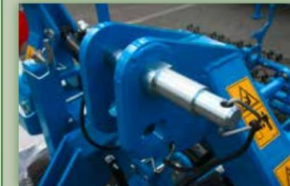
Aufhängung mit Steckbolzen als Verdrehsicherung
