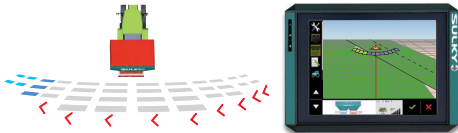
Bei geschlossener rechter Seite werden die Teilbreiten auf der linken Seite nach und nach von der Mitte nach außen hin geschlossen
