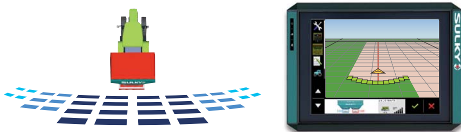
ECONOV mit ISOBUS schaltet 12 Teilbreiten unabhängig von der Arbeitsbreite (hier bei voller Streubreite mit 12 geöffneten Teilbreiten)
