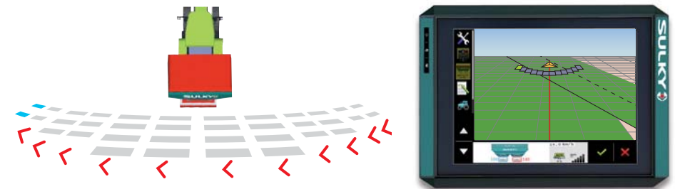
Nur eine Teilbreite ganz außen ist am Ende der Streuarbeit in Feldkeilen offen
