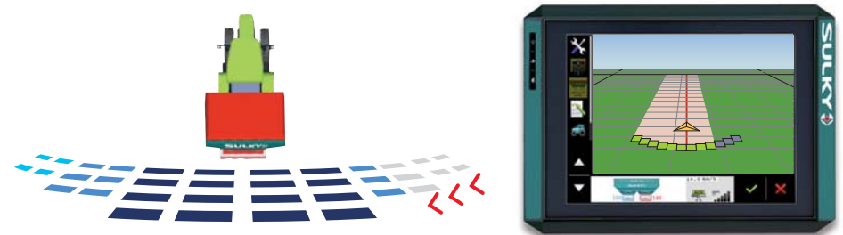
Bei abnehmender Streubreite, z.B. bei der letzten Überfahrt, werden die Teilbreiten in Abhängigkeit von der noch zu streuenden Breite automatisch geschlossen (hier: 3 geschlossene Teilbreiten auf der rechten Seite)
