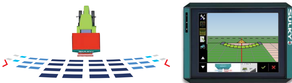
Bei Erreichen eines geraden Vorgewendes werden die Teilbreiten nach und nach von außen nach innen geschlossen und bilden damit das reelle, nämlich BOGENFÖRMIGE Streubild nach.
