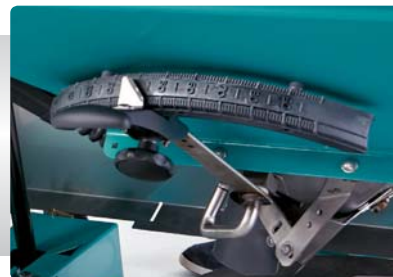
Neue, gut lesbare Skala für eine auf das Kilogramm genaue Mengeneinstellung
