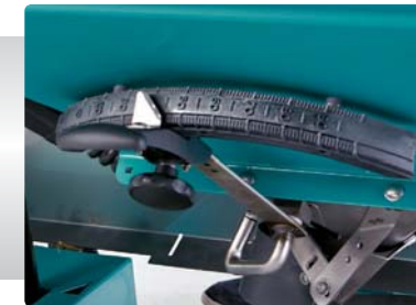
Neue, gut lesbare Skala für eine auf das Kilogramm genaue Mengeneinstellung
