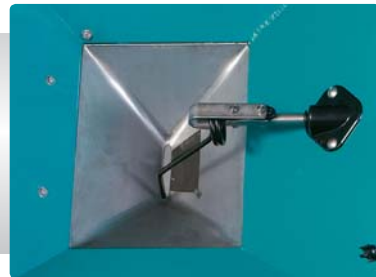
Edelstahlboden mit Pendelfinger-Rührwerk
