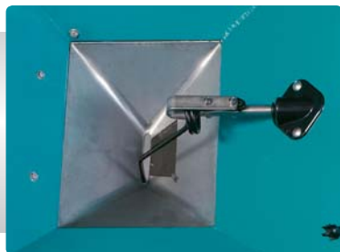
Edelstahlboden mit Pendelfinger-Rührwerk
