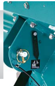
Neigungsanzeiger für Spätdüngung
