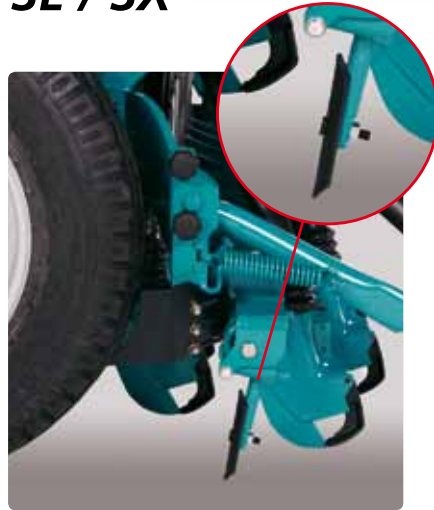
Spurlockerer für die Räder der Drillmaschine mit 2 Zinken und Non-Stop-Steinsicherung (Zusatzausrüstung)
