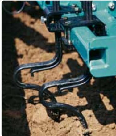
Spurlockerer für die Traktorräder mit 4 Zinken (Zusatzausrüstung)
