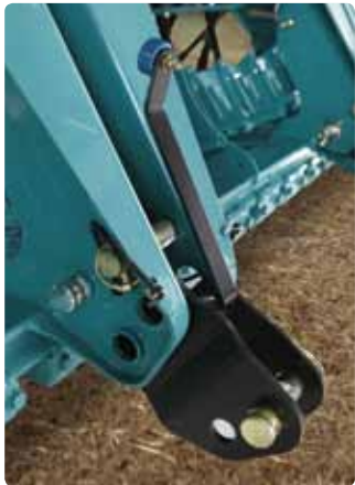
Fahrgassenzähler ohne Spuranreißer (Zusatzausrüstung) und pendelnde Anbauvorrichtung (Zusatzausrüstung)
