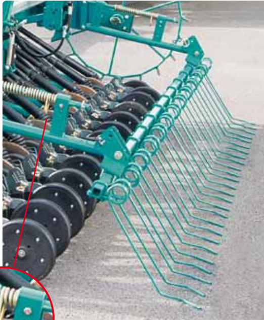
Striegel mit Nivellierzinken, ergonomischen Einstellgriffen und Gelenken in verstärkter Ausführung
