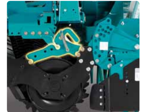
Abstützung der Packerwalze auf der Kreiselegge CULTILINE Sulky
