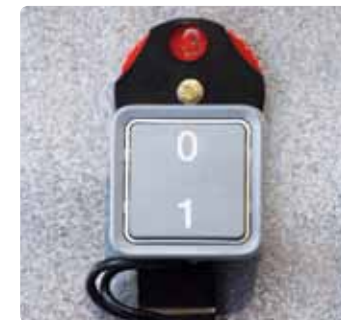
Elektrische Betätigung des Fahrgassenzählers mit Anzeige der Fahrgassen (Zusatzausrüstung)
