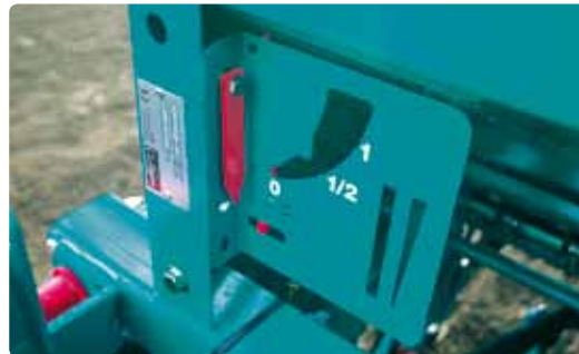
Anzeigen für Füllstand im Behälter, Neigung und Fahrgassen
