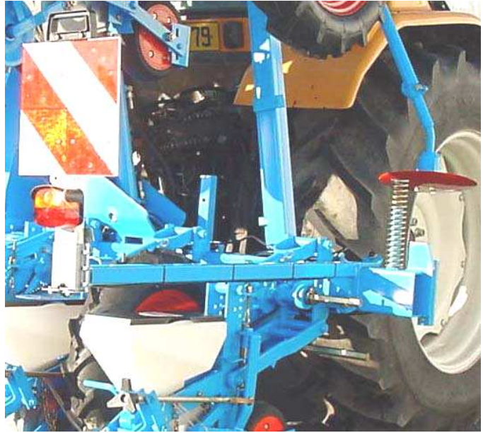
Montage du support sur MECA V4 Assembly of the support bracket on the MECA V4 planter Montage des Beleuchtungshalters an der MECA V4 Sämaschine
