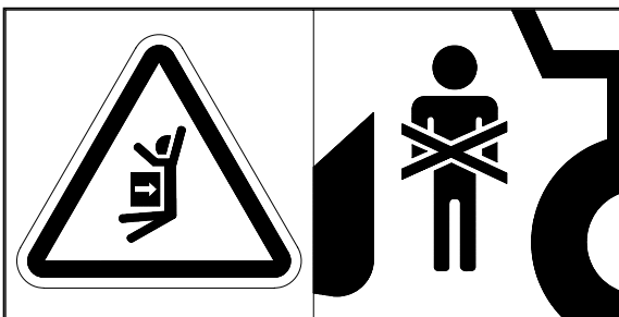
Niemals in den Gefahrenbereich zwischen Vorsatzgerät und Maschine treten!
