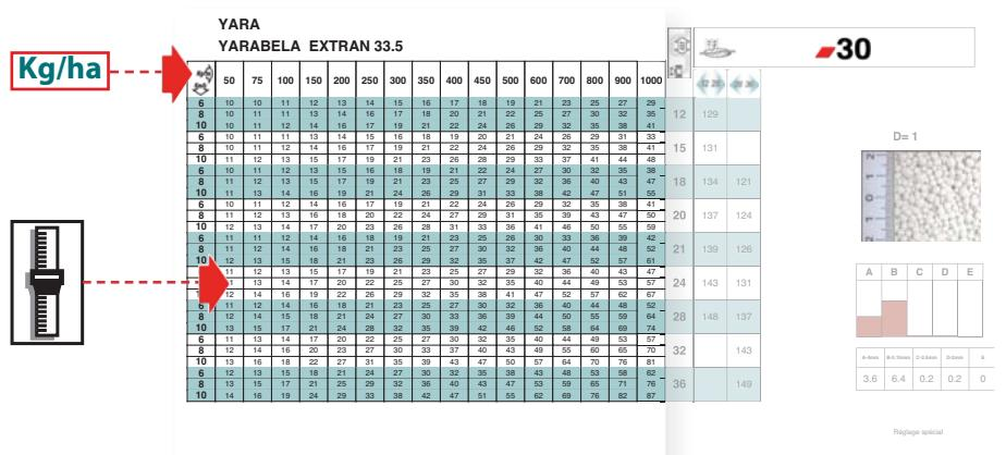
**La réalisation de l'essai de débit est vivement conseillée pour avoir une bonne précision de réglage. Les tableaux de réglage ne sont donnés qu'à titre indicatif. Utiliser la réglette pour déterminer votre réglage. Cette méthode pratique tient compte des différentes conditions influant le débit.**
