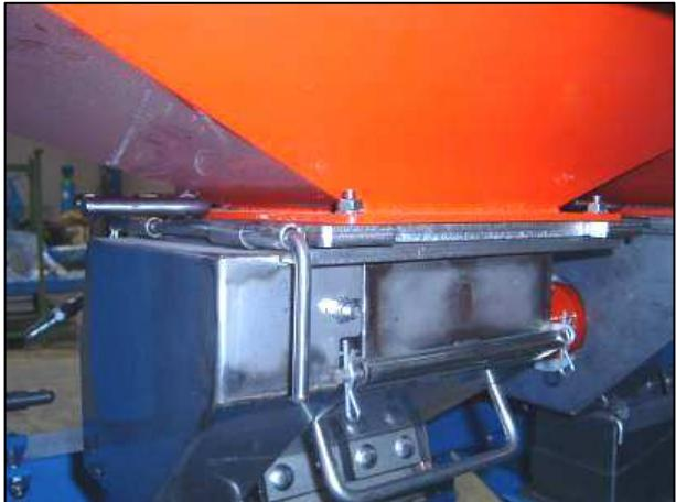
Ouverture et verrouillage d'une trappe
