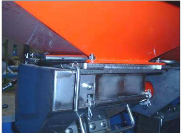
Fermerture et verrouillage d'une trappe
