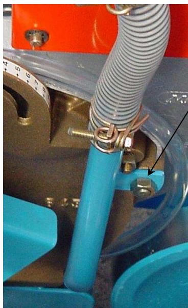
Fixation du tuyau de descente sur le boîtier
