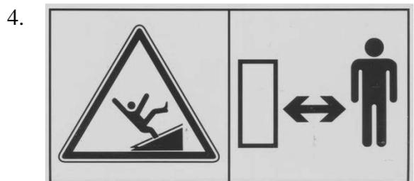
Der Aufenthalt im Gefahrenbereich ist nur bei eingelegter Hubzylindersicherung zulässig.
