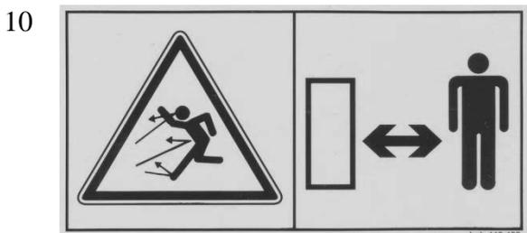
Schutzeinrichtungen bei laufendem Motor nicht öffnen oder entfernen.
