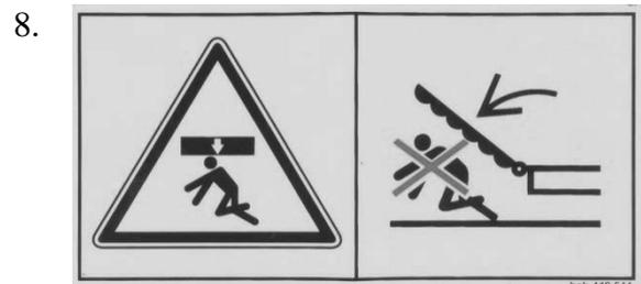
Bei eingeschaltetem Antrieb und laufendem Dieselmotor ausreichend Abstand zum Mähmesser halten. (Best.-Nr. 510905)
