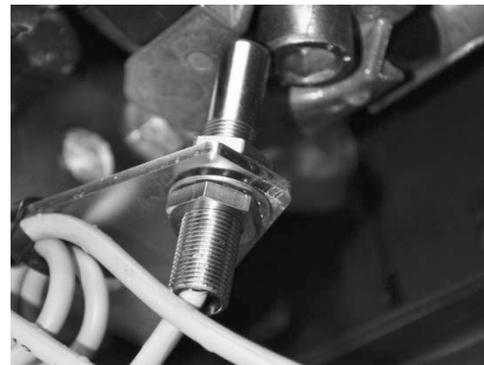
Sensor Drehzahlabnahme unterhalb der Maschine
