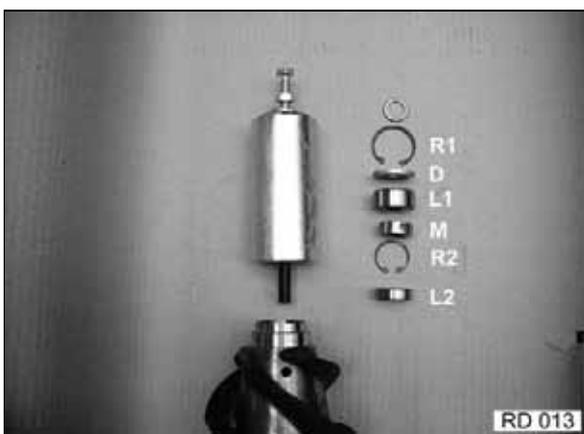
**Lager aus Rotor entfernen**
