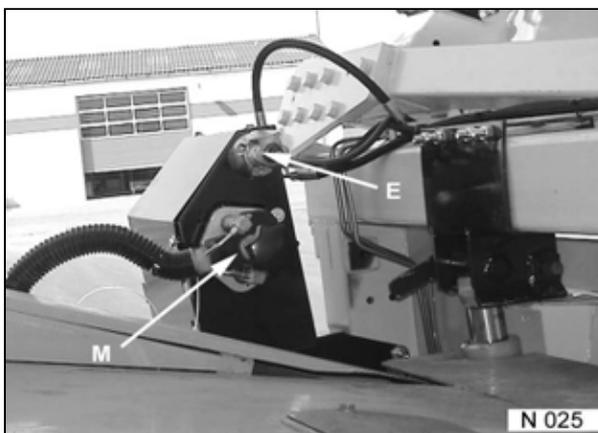
**Frontschutz mit Beleuchtungsanschluss**
