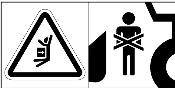
Niemals in den Gefahrenbereich zwischen Vorsatzgerät und Maschine treten!
