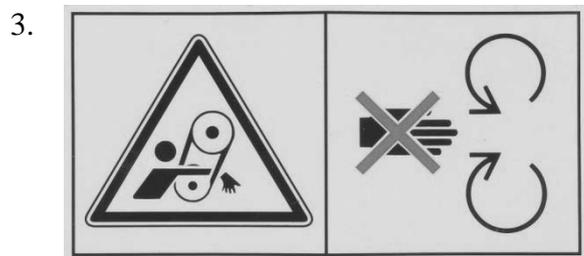
Ausreichenden Sicherheitsabstand zum Erntevorsatz einhalten. Vor Wartungsarbeiten oder Beseitigung von Verstopfungen, Erntevorsatzantrieb abschalten, Motor abstellen und Schlüssel abziehen.
