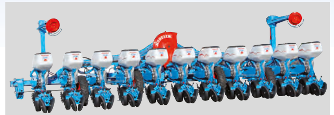
11-reihige, klappbare Doppelbalken-Sämaschine (60 cm Reihenabstand)
