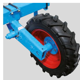
Standard-Andruckrolleneinheit mit 6,5x80x15-Rolle
