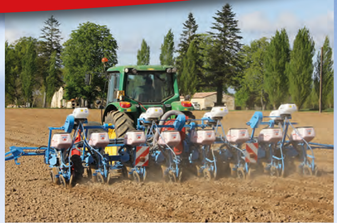
8-reihige, klappbare Doppelbalken-Sämaschine (80 cm Reihenabstand)
