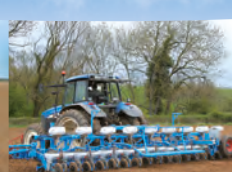
Mechanische Einzelkornsämaschine Typ MECA V4 für Zuckerrüben
