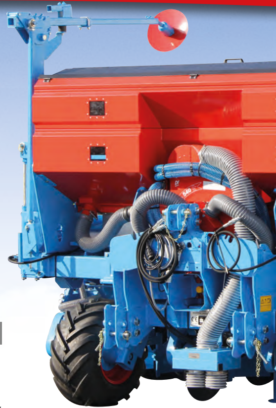
6-reihige Monoblock2 Komfort Sämaschine mit 1030 L Düngerstreuer und Microsem Kombination (75 cm Reihenabstand)
