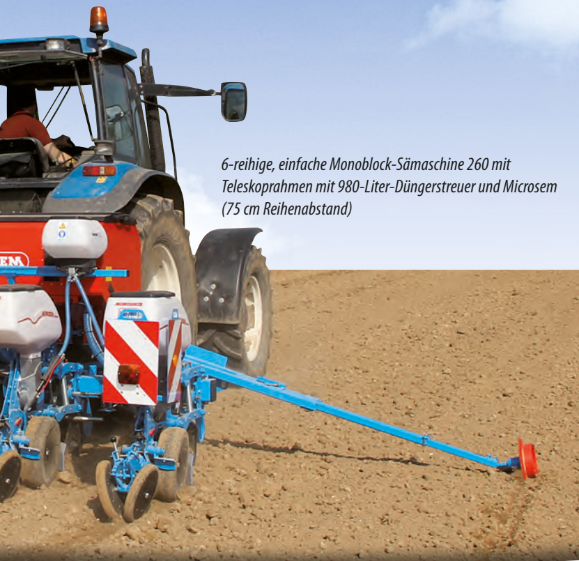
6-reihige, einfache Monoblock-Sämaschine 260 mit Teleskoprahmen mit Microsem Kombination (75 cm Reihenabstand)
