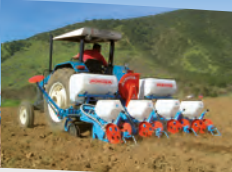
Pneumatische Einzelkornsämaschine Typ NC mit Schar
