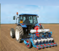
Spezial Gemüsesämaschine Typ MS für Feinsaat
