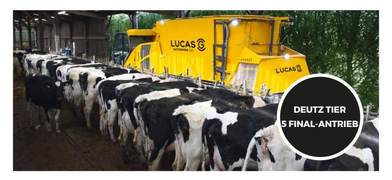
Der selbstfahrer Autospire wurde für tägliche Fahrten von über 70 km am Tag entwickelt. Die Maschinen sind mit breiten LKW-Reifen und einem Bremssystem mit 4 Scheibenbremsen für eine optimale Straßenlage und Sicherheit bei 40 km/h ausgestattet. Die vordere hydropneumatische Federung und die hintere Parabolblattfederung sorgen für eine komfortable und reibungslose Fahrt für den Fahrer.
