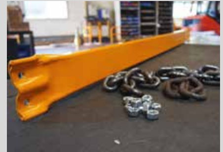
Kratzboden Total geschraubt für eine einfache Wartung.
