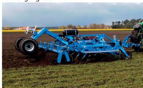
Zinken 80x12 Standard + Gegenfeder + Standard Wendeschar 65x8x295 Durchgang 650 mm
