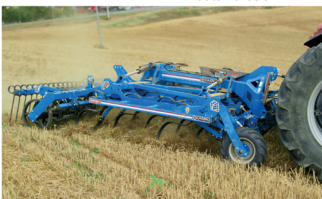
Standard 80 x 12 Zinke + reversierbares Standardschar 65 x 8 x 295 Abstand 650 mm
